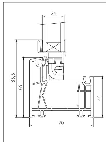
**Isolierglas 24 mm, Ug-Wert 1,1 W/(m<sup>2</sup>K)**
